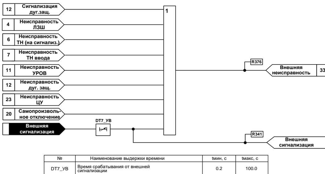
Рисунок 24 – Функциональная схема предупредительной сигнализации
