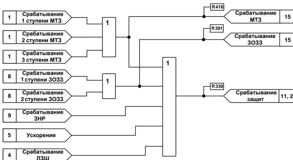
Рисунок 25 – Функциональная схема срабатывания защит
