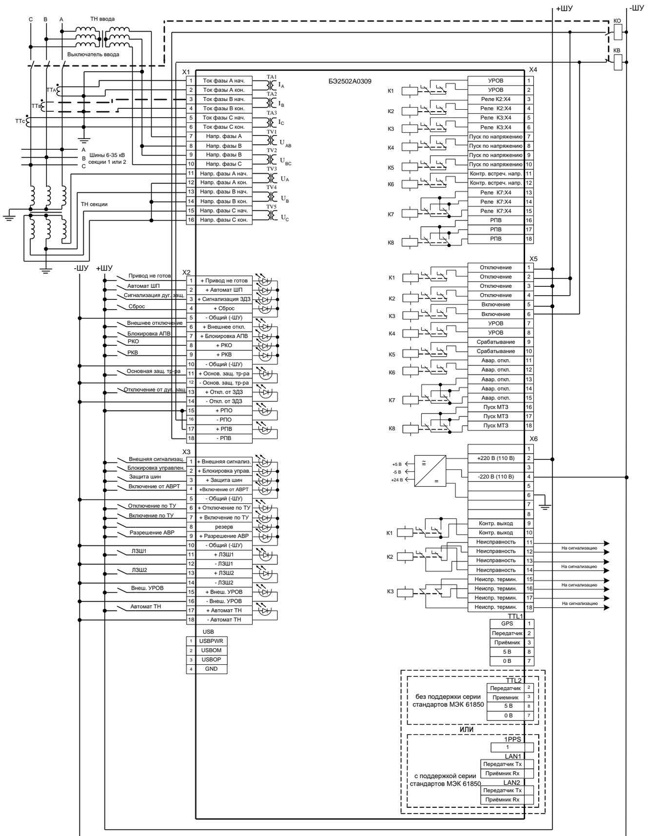
Рисунок В.2 – Пример подключения внешних цепей к терминалу БЭ2502А0309
