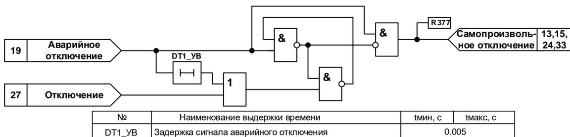
Рисунок 20 – Функциональная схема формирования сигнала самопроизвольного отключения
