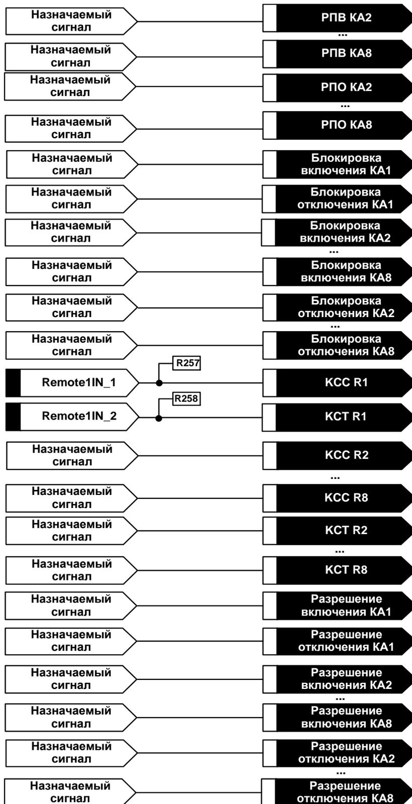
Рисунок 36 – Конфигурируемые входы для дистанционного управления коммутационными аппаратами
