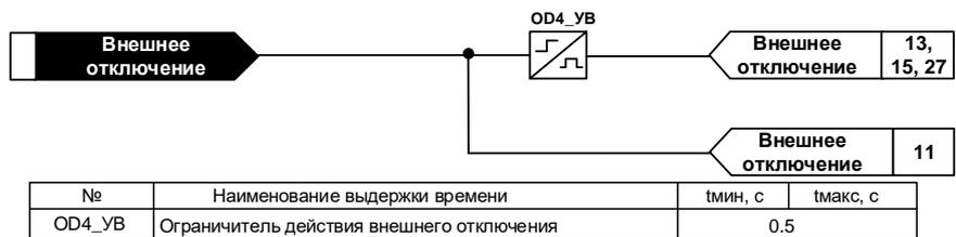
Рисунок 26 – Функциональная схема внешнего отключения
