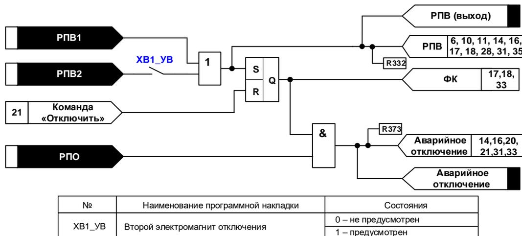
Рисунок 19 – Функциональная схема формирования сигнала аварийного отключения
