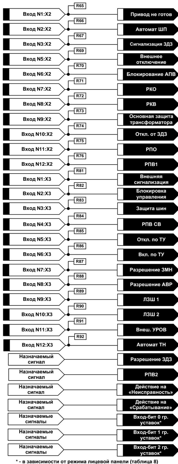
Рисунок 30 – Конфигурируемые дискретные входы
