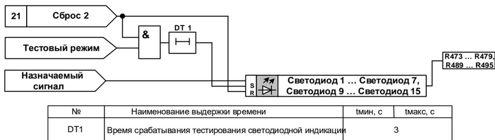
Рисунок 32 – Конфигурируемые светодиоды
