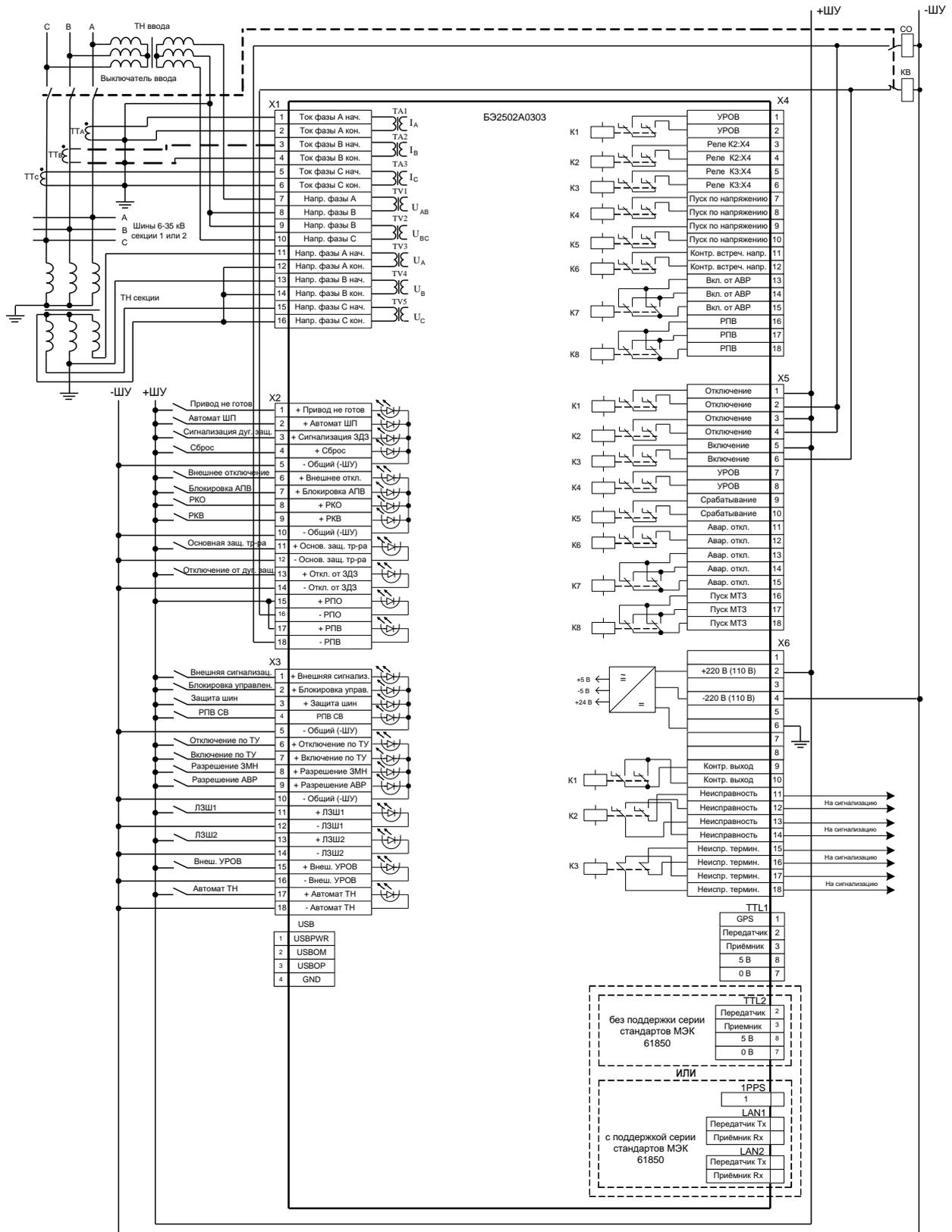
Рисунок В.1 – Пример подключения внешних цепей к терминалу БЭ2502А0303
