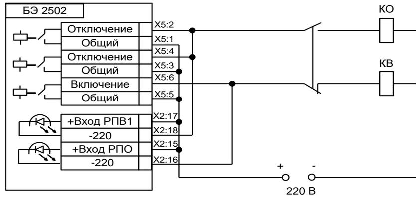
Рисунок 22 – Схема соединения цепей контроля положения выключателя
