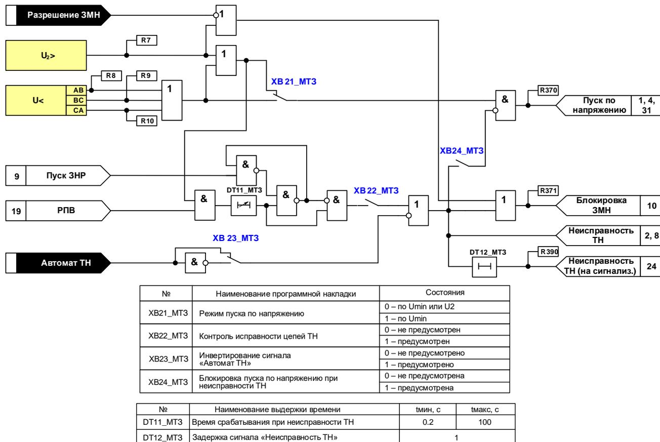
Рисунок 6 – Функциональная схема пуска по напряжению
